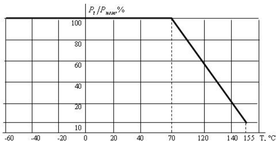
P<sub>t</sub> — допустимая мощность рассеяния, Вт;
